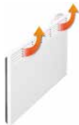
Uitlaatopening aan de voorzijde voorkomt stofnesten
