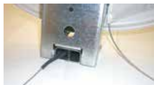
Verwarmingskabel voor het verwarmen van de ontvangerarm
