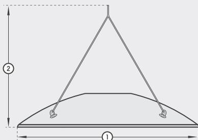
1. **Diameter** | Diamètre total      Ø 800 mm
