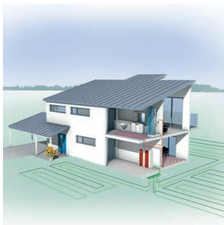
Bodem/water warmtepomp met horizontale collectoren
